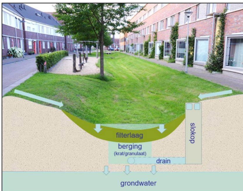
Figuur 10: Dwarsdoorsnede van een wadi. Bron: Kennisportaal Klimaatadaptatie.
