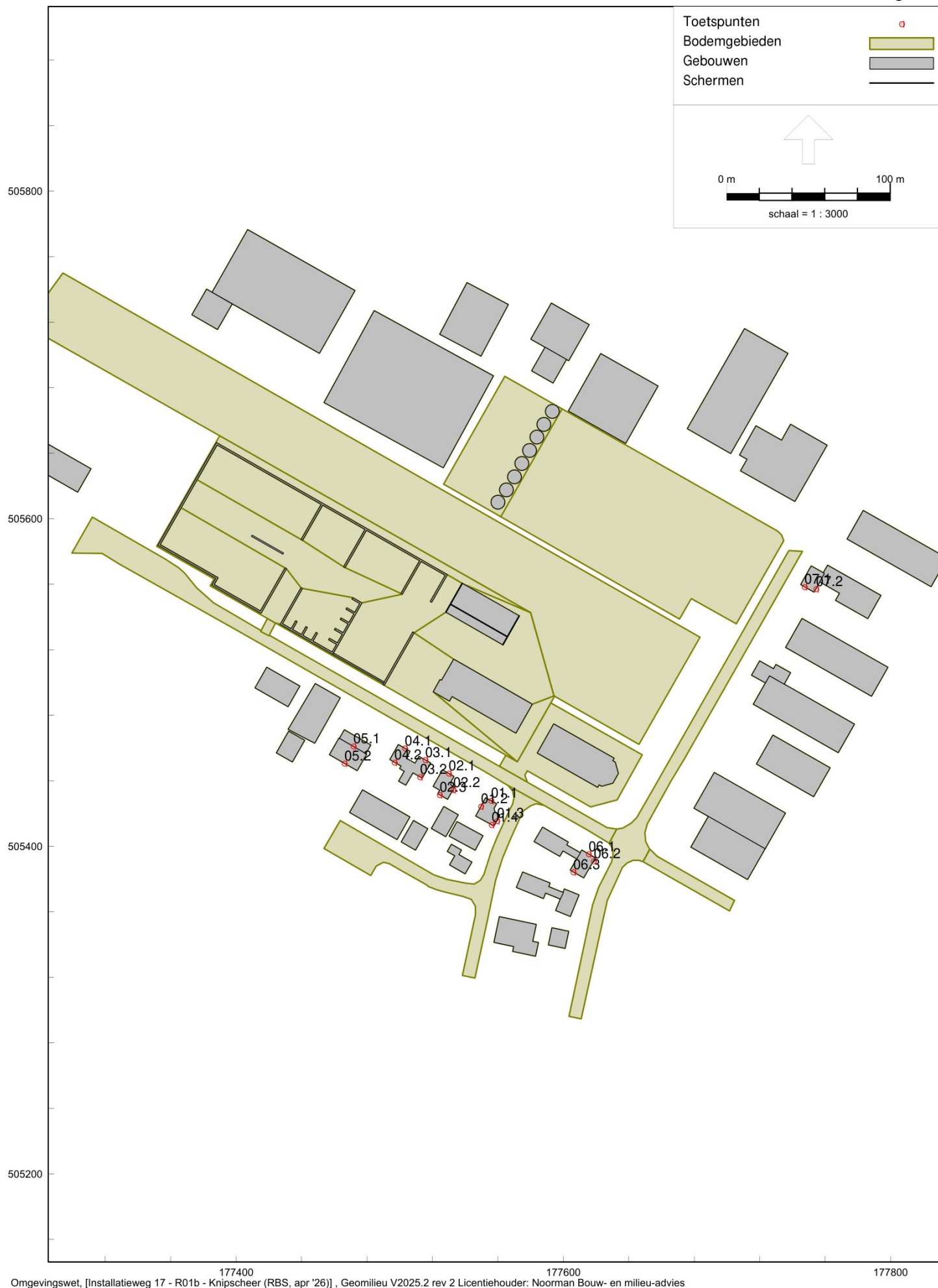
Overzicht van het akoestische rekenmodel met de ligging van de objecten
