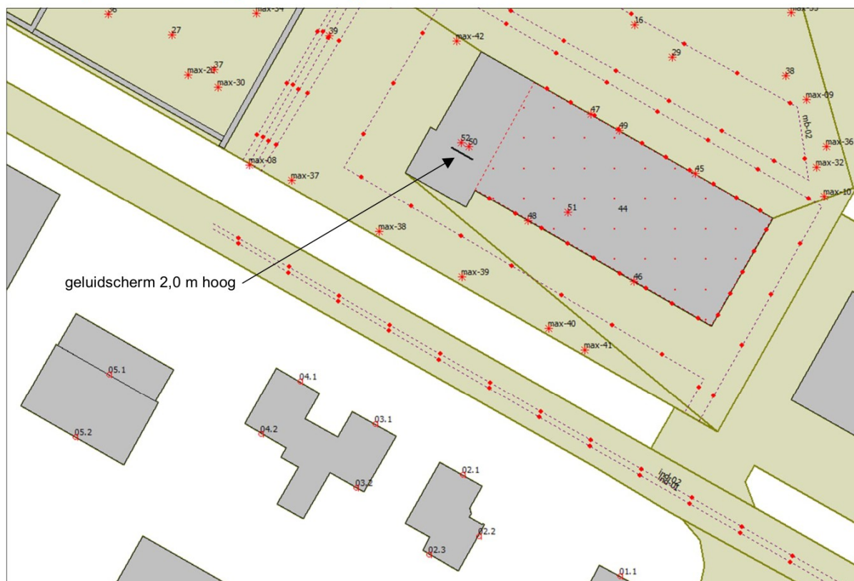
Afbeelding 4: Aanduiding geluidscherm gebouwinstallaties
