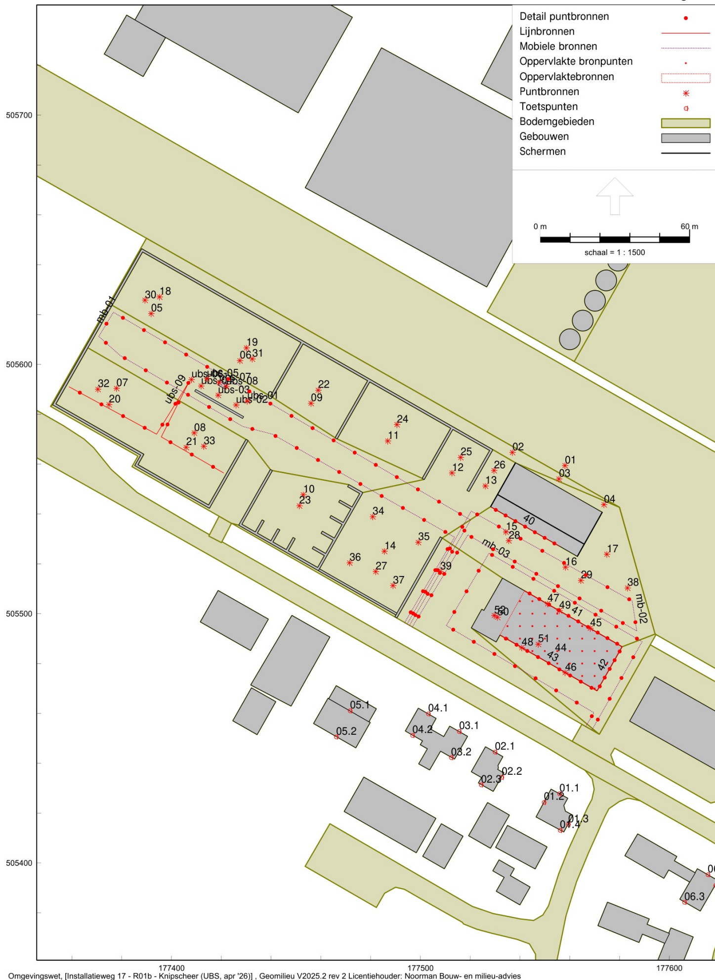
Overzicht van het akoestische rekenmodel met de ligging van de equivalente geluidbronnen (LAR,LT) - UBS
