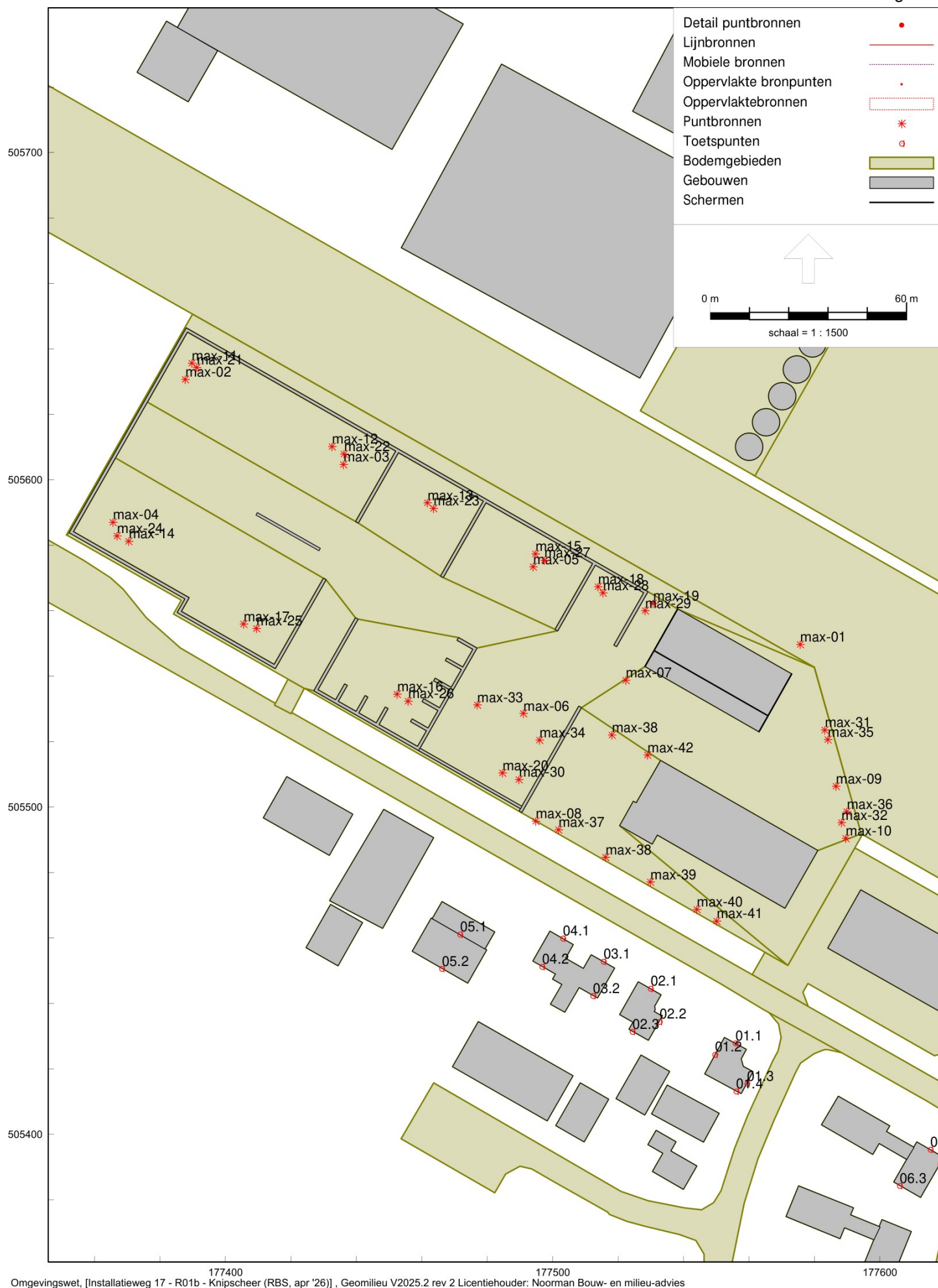
Overzicht van het akoestische rekenmodel met de ligging van de maximale geluidbronnen (LMax) - RBS / UBS
