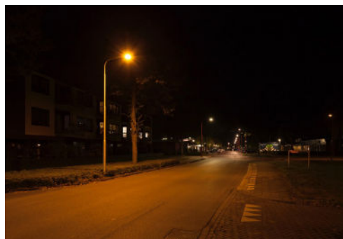
Foto: De Baan in Biddinghuizen. Op de voorgrond oudere verlichting die alle kanten op schijnt en op de achtergrond nieuwe ledverlichting. Gericht licht op de weg en heel efficiënt.
